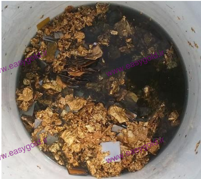
شکل ۱۳-۵: روکش‌های طلایی که از درب‌های پردازنده‌ها جدا شده‌اند.
